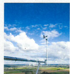
Girouette Mesure les directions du vent
