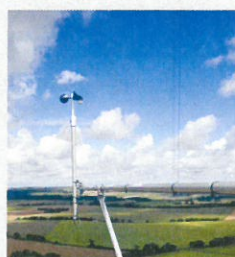
Anémomètre Mesure la vitesse et la pression du vent
